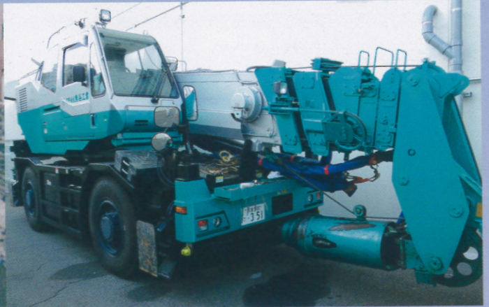
使用機械：10t ラフター 東京都目黒区（首都高速目黒線高架下）杭 H300 L=10.0m ミルク注入 H 鋼打設 桁下 GL+6.5m
